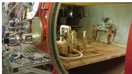
Mars simulatoren på Aarhus Universitet, der kan genskabe vind, temperatur og fugtighedsforhold på Mars' overflade har siden 2010 været anvendt i 24 industrikontrakter for ESA, NASA og underleverandører til disse organisationer. Foto © Aarhus Universitet
